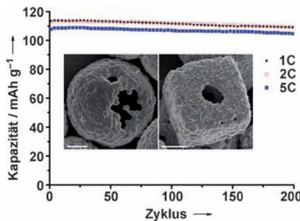
**Auf Dauer angelegt:** Einheitliche, hohle Mikrokugeln und -würfel aus LiNi<sub>0.5</sub>Mn<sub>1.5</sub>O<sub>4</sub> (siehe Bild; Skalierung: 1 μm) aus nanoskaligen Bausteinen wurden durch eine einfache Imprägnierungsmethode, gefolgt von einer simplen Festkörperreaktion synthetisiert. Die Hohlstrukturen weisen eine Entladungskapazität von 120 mAh g<sup>-1</sup> über viele Zyklen auf und zeigen exzellente Entladungsraten.
